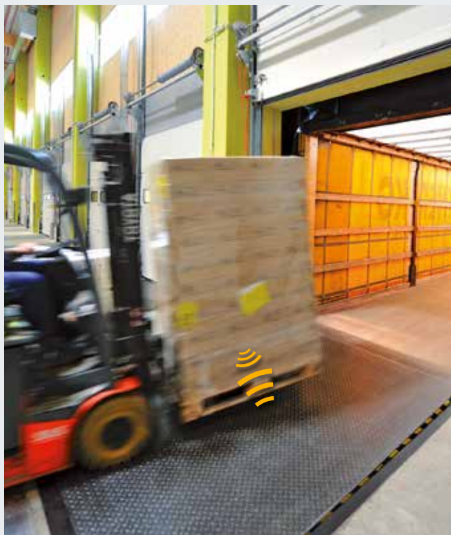
Automatyczne ewidencjonowanie przepływu towarów podczas przejeżdżania przez rampę przeładunkową.
